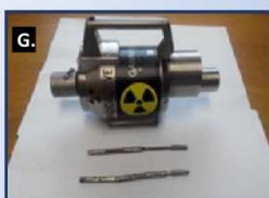
G - GAMMAMAT – najrozšírenejší typ defektoskopického krytia
