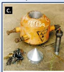
C - Kontajner merača obsahu popola (m = 25 kg)
