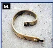
M, N - Súčiastky poľnohospodárskych strojov, vyrobené z tavby kontaminovanej ^{60}\text{Co}
