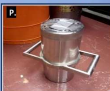
P - UK14 tienenie z uránu, použitie pre transport nosičov uzavretých zdrojov ionizujúceho žiarenia ( ^{192}\text{Ir} , ^{75}\text{Se} )
