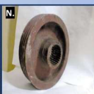
M, N - Súčiastky poľnohospodárskych strojov, vyrobené z tavby kontaminovanej ^{60}\text{Co}
